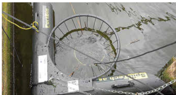
Mit der Installation von PortBins, innovativen wassertauglichen Abfallbehältern, wird ein Jahr lang Plastikmüll in der Warnow zur weiteren Untersuchung gesammelt, bevor er in die Ostsee gelangt und zu Meeresmüll wird. Foto: Laura Avellan/Universität Rostock
