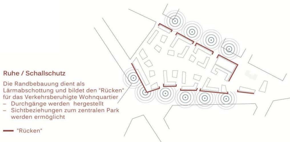
Abbildung 6: Detailkonzeption Ruhe Schallschutz (Quelle Albert Wimmer ZT-GmbH, 2016)
