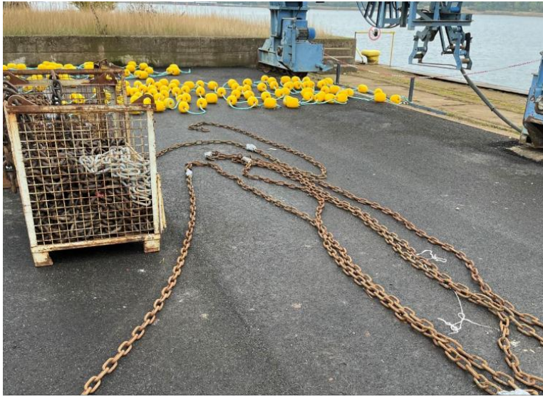
Abbildung 8: Ankerketten (Ballastierung) und Schwimmer zum Einziehen; Referenzprojekt Muddebaggerung Seekanalvertiefung WSA Ostsee (Quelle: Boskalis)
