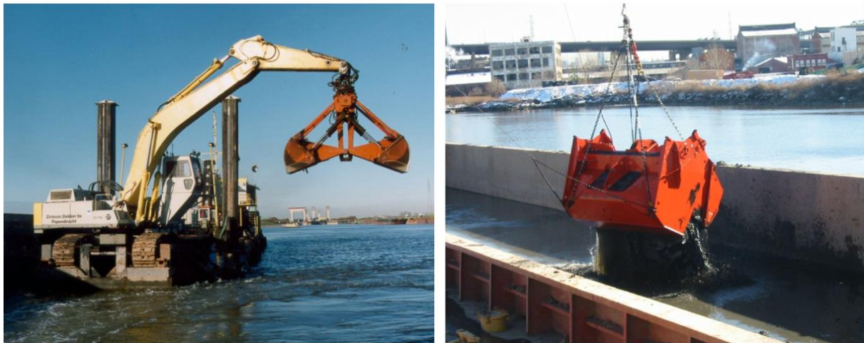
Abbildung 11: Geschlossener Greifer für Nassbaggermaßnahmen, horizontal (Bild links) schließend
