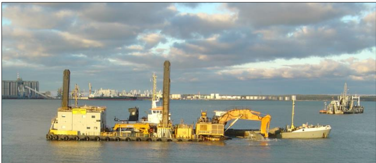
Abbildung 17: beispielhafter Hydraulikbagger (Backhoe) mit Schutenbeladung
