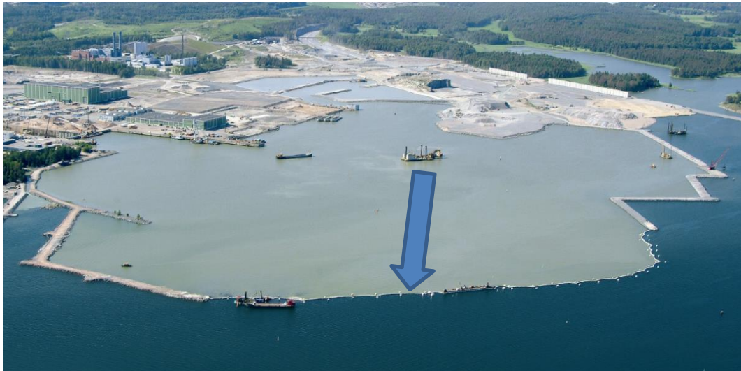
Abbildung 27: Schlickvorhang im Projekt Vuosari, Finnland (Quelle: CEDA, IADC (2018))
